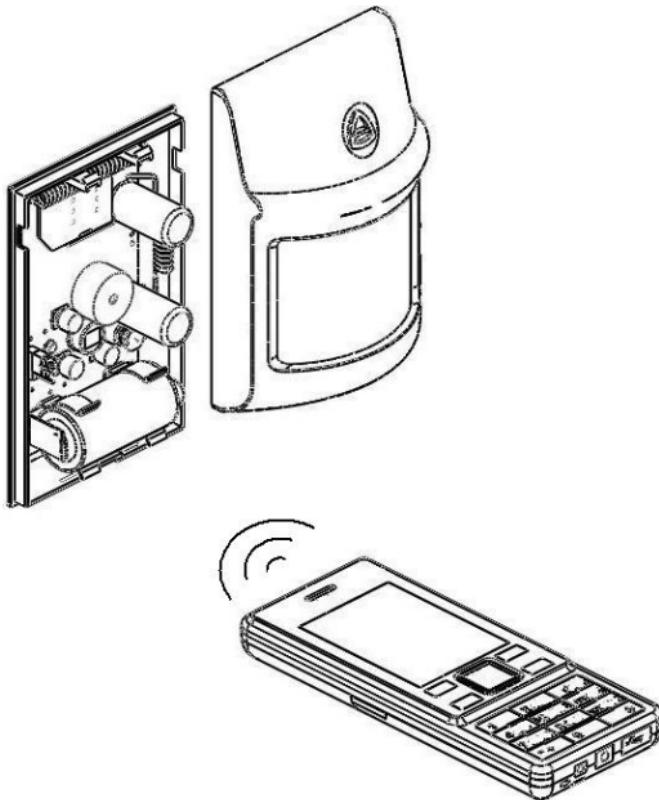
После того как прозвучит 3 коротких звуковых сигналов, в течение **30 секунд** необходимо позвонить на номер SIM карты сигнализатора с сотового телефона.
