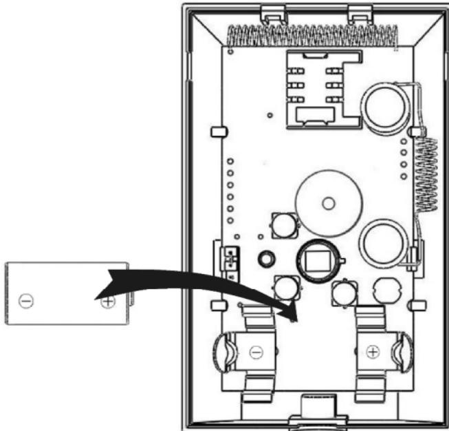
Установите батарею в разъем сигнализатора, соблюдая полярность.
