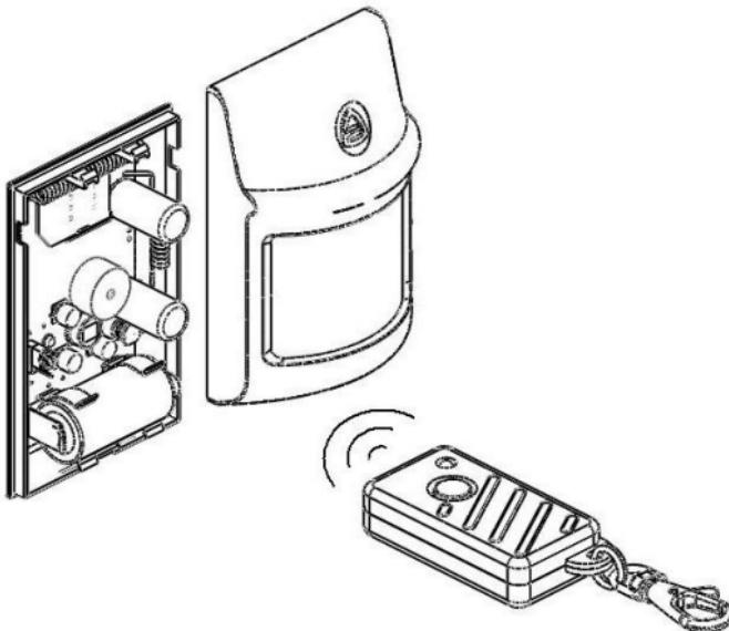
С момента окончания вызова у вас есть **30 секунд**, за которые нужно кратковременно нажать кнопку брелка. После её нажатия сигнализатор запишет брелок в свою память. В процессе записи светодиод поочередно мигает красным и зеленым. По окончании записи прозвучит один звуковой сигнал.
