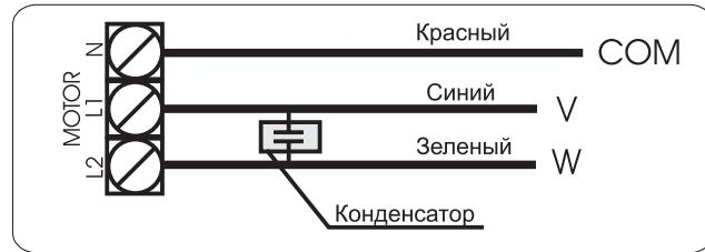
Проверьте, чтобы двигатель был подключен, как показано на рисунке.
